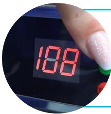
Druk het apparaat aan en stel de temperatuur in op 108 graden. De destilleerde zal nu begonnen met destilleren. Vergeet niet om te checken of de glazen kan juist onder het uitlaatfilter staat. Binnen een halfuur zal het eerste gedestilleerde water uit de kan druppelen. Binnen 4 uur zal de kan gevuld zijn met water en zal de destilleerde de melding 'E' geven, zo weet je dat het bassin leeg is en het proces is afgerond.
