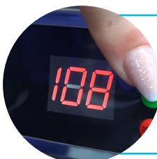
Drücken Sie das Gerät und stellen Sie die Temperatur auf 108 Grad ein. Der Destillierapparat beginnt nun mit dem Destillieren. Vergessen Sie nicht zu prüfen, ob die Glaskanne richtig unter dem Abluftfilter positioniert ist. Innerhalb einer halben Stunde tropft das erste destillierte Wasser aus der Kanne. Innerhalb von 4 Stunden ist die Kanne mit Wasser gefüllt und der Destillierapparat gibt die Meldung „E“ aus, sodass
