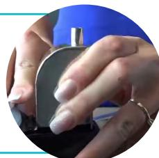
Entferne anschließend den Abluftfilter, indem du ihn in Richtung Kopf schiebst und dann kippst. Überprüfe, ob sich hier tatsächlich ein Kohlefilter befindet. Dieser Filter entfernt die letzten Gerüche und Aromen, die bei der Destillation freigesetzt werden. Sobald du den Filter wieder eingesetzt hast, kannst du die Kopfeinheit auf das Becken stellen und die Stromkabel in die Einheit und die Steckdose stecken.
